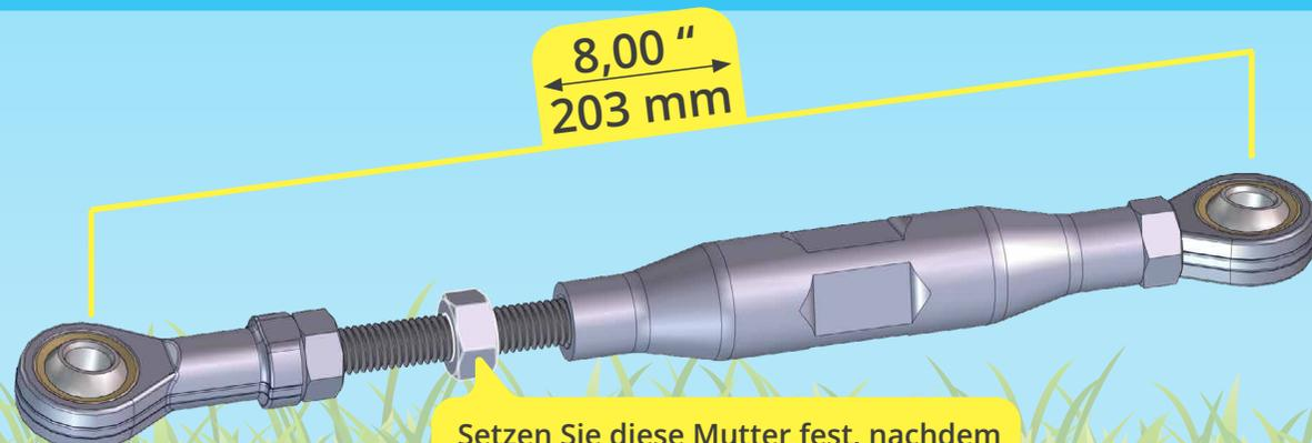
Setzen Sie diese Mutter fest, nachdem die Lenkstange auf dem Lenkarm und der Lenkplatte montiert ist.
